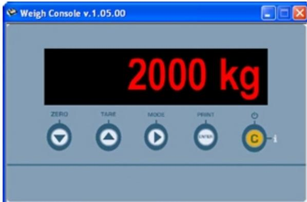
Logiciel gratuit (si téléchargé sur notre site internet) qui permet le monitoring par l'ordinateur du poids affiché des indicateurs DFW, 3590, DGT, DGTQ, DGT60, CPW, TRS et TRI.
